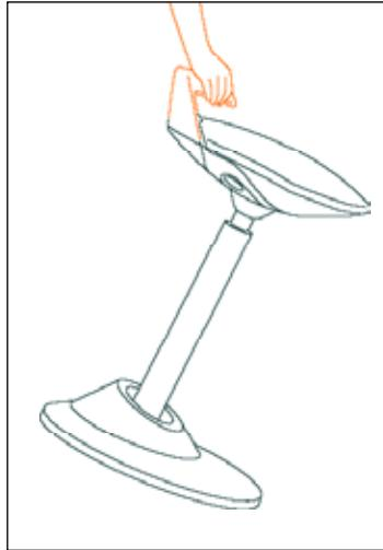
**Um den movman zu tragen**, fahren Sie die Höheneinstellung am Sitz nach unten. Zum Tragen verwenden Sie bitte den Sitzgriff. Vermeiden Sie die Berührung der Gasdruckfeder, da diese gefettet ist.
